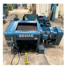
**HOIST 12.5 Tons Demag**
