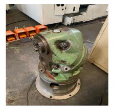
VERTICAL MILLING HEAD SPINDLE ISO40
